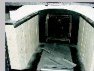
CAMERA DI COMBUSTIONE INTERAMENTE RIVESTITA IN REFRETTARIO
